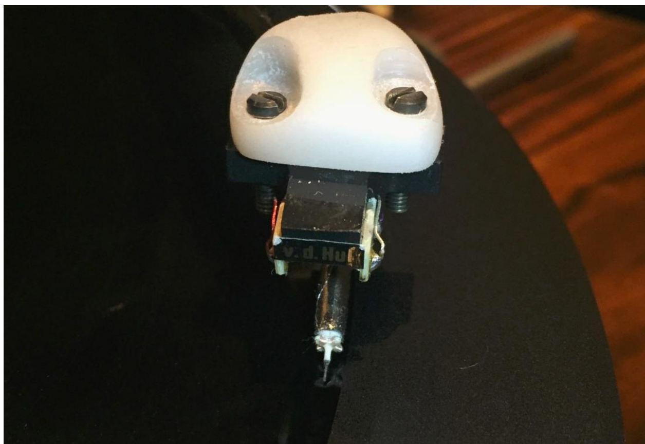
Fig. 7: De naald nogmaals op de plaat en het spiegelbeeld van het spoelanker in de opzetgroef
